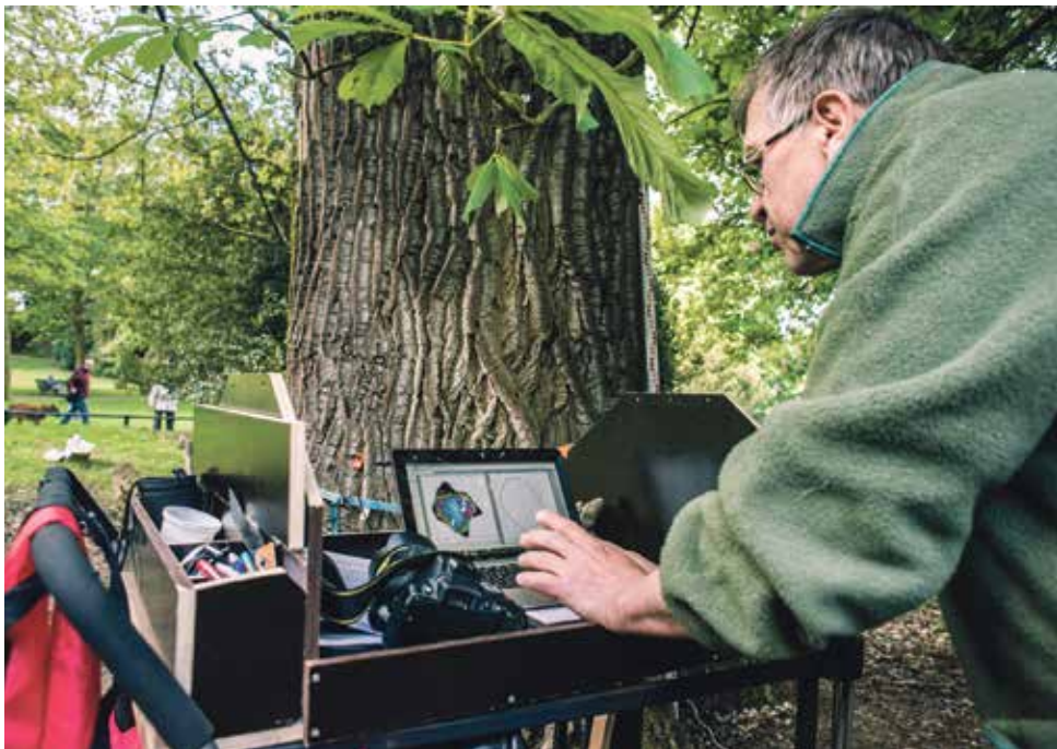
L’expert Paul Gourgue in actie au parc Josaphat. A l’aide d’un tomographe, il réalise un scanner de l’intérieur de l’arbre.
